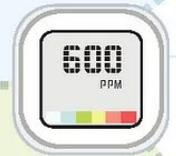
Utiliser un moniteur de CO2 avec un capteur infrarouge non dispersif (NDIR)
